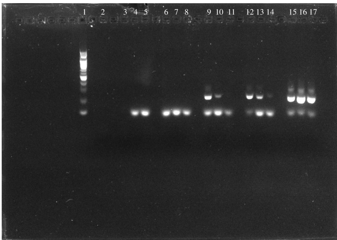
Obrázek 20 Agarózová gelová elektroforéza produktů PCR (200 bp), při použití primerů CAD1C (200 nM)
