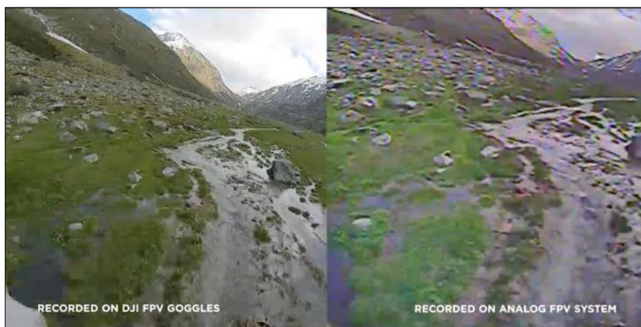
Obrázek 29 – porovnání digitálního a analogového DVR zdroj: https://cdn.fstoppers.com/styles/medium/s3/media/2019/10/22/screen_shot_2019-10-22_at_12.01.14_pm.png?itok=xE1B0A5b&timestamp=1571760106
