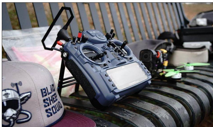
Obrázek 32 – vysílač FrSky Taranis XD9 Plus s CrossFire modulem zdroj: https://www.yawspin.com/wp-content/uploads/2018/07/stele-radio-960x570.jpg
