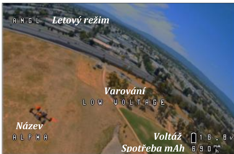
Obrázek 53 – náhled rozmístění elementů na OSD, vysvětlivky: autor zdroj: autor
