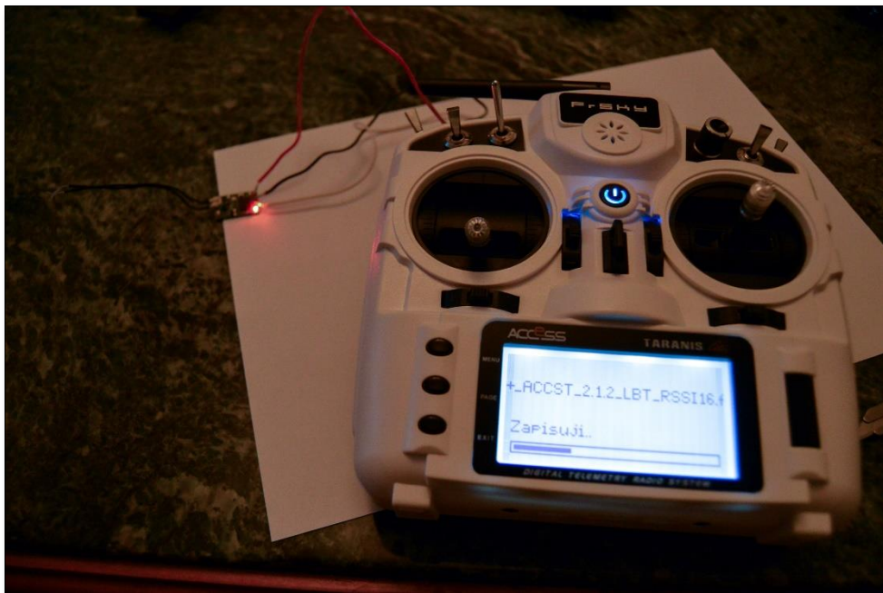
Obrázek 56 – zapisování XM+_ACCST_2.1.2_LBT_RSSI16 firmwaru do přijímače zdroj: autor
