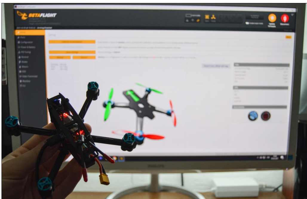
Obrázek 46 – kalibrace gyroskopu a akcelerometru řídicí jednotky zdroj: autor
