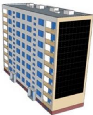
Obrázek 33 Schéma fotovoltaických panelů na štítu panelového domu (30)
