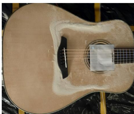
Obr. 6.45: 3. rezonanční mód kytary DRMI
