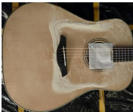
Obr. 6.45: 3. rezonanční mód kytary DRMI
