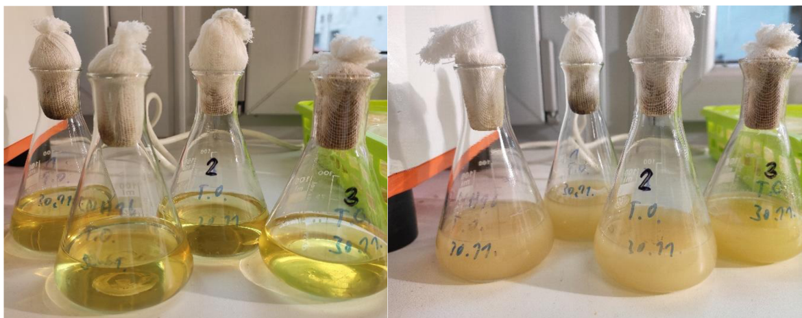
Obrázok 14: Kultivácia baktérii Cupriavidus necator H16 a C. maleysiensis na začiatku (vľavo) a po 24 hodinách na trepačke (vpravo)
