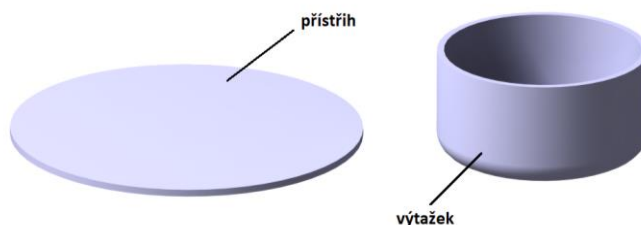
Obr. 10 Tvorba válcového výtažku
