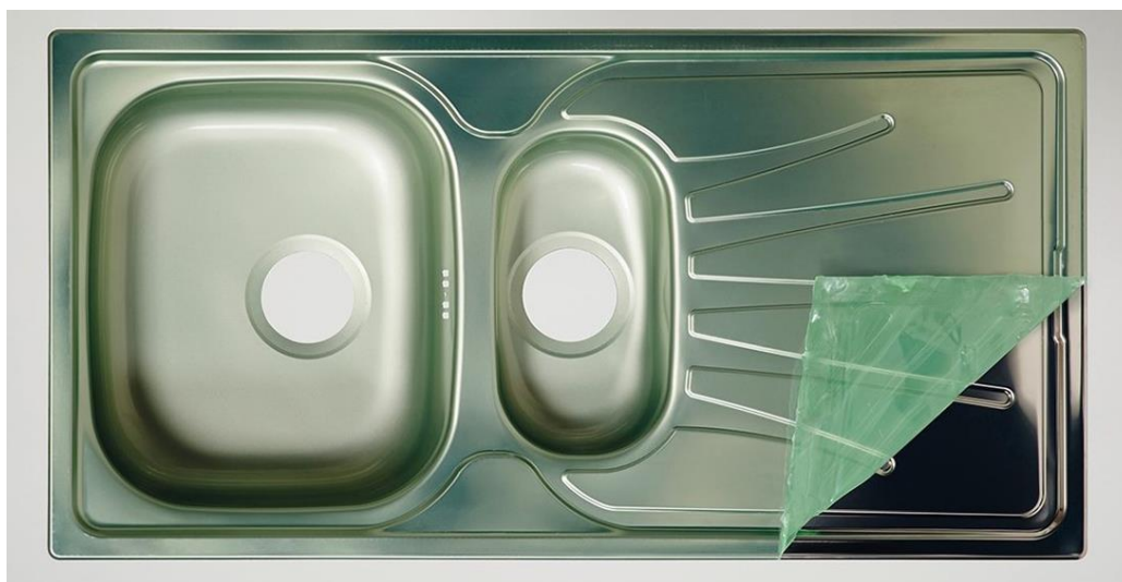
Obr. 45 Sejmutí filmu plastické hmoty z hotového výtažku [37]
