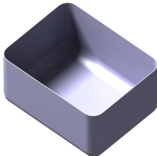
Obr. 49 Model řešené součásti po tažné a ostříhvací operaci
