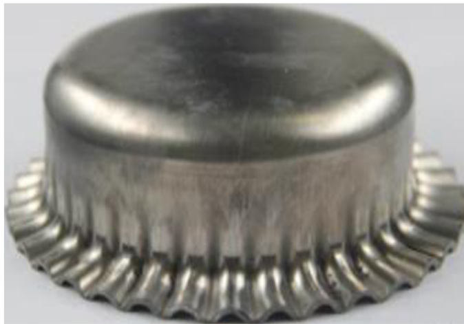
Obr. 32 Ukázka zvlnění výtažku [30]
