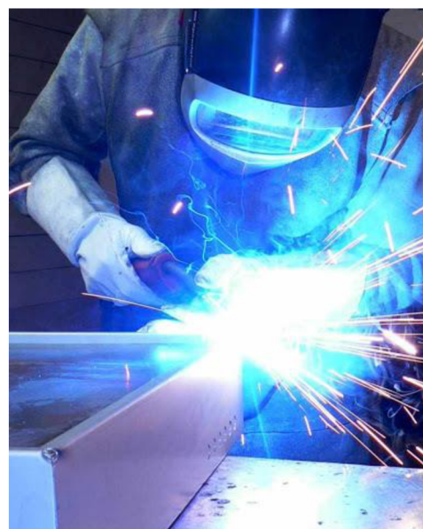
Obr. 6 Výrobek zhotoven kombinací ohybu a svaru [14]
