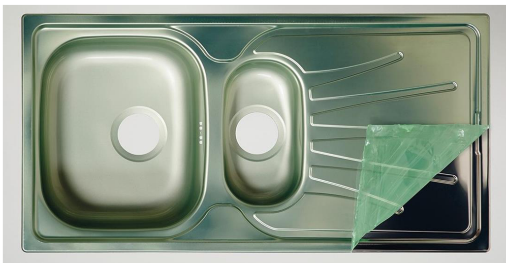
Obr. 45 Sejmutí filmu plastické hmoty z hotového výtažku [37]
