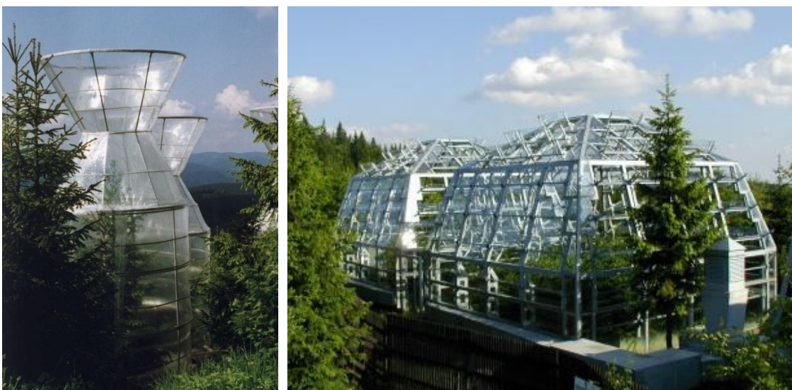
Obr. 11 Vlevo komory s otevřeným vrchem, ve kterých byli kultivováni jedinci smrku (celkem 4ks v přirozené a 4 ks v dvojnásobné vzdušné koncentraci CO 2 ) v letech 1992-1995 (v rámci projektu ECOGRAFT); vpravo lamelové kultivační sféry pro kultivaci stromů v porostním měřítku.
