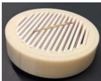
Obrázek 1.8 Koncept substrátu z tenkých pásů [5]
