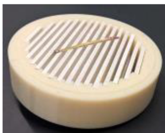
Obrázek 1.8 Koncept substrátu z tenkých pásů [5]
