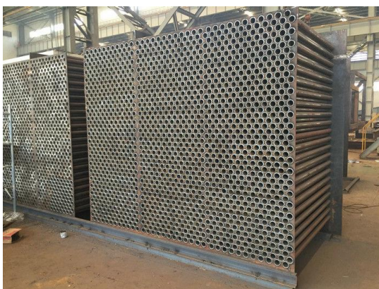
Obrázek 7 - trubkovnice pro trubkový výměník tepla [11]
