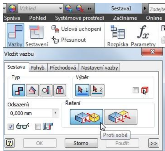
Obr. 30 – Vložení vazby (proti sobě)
