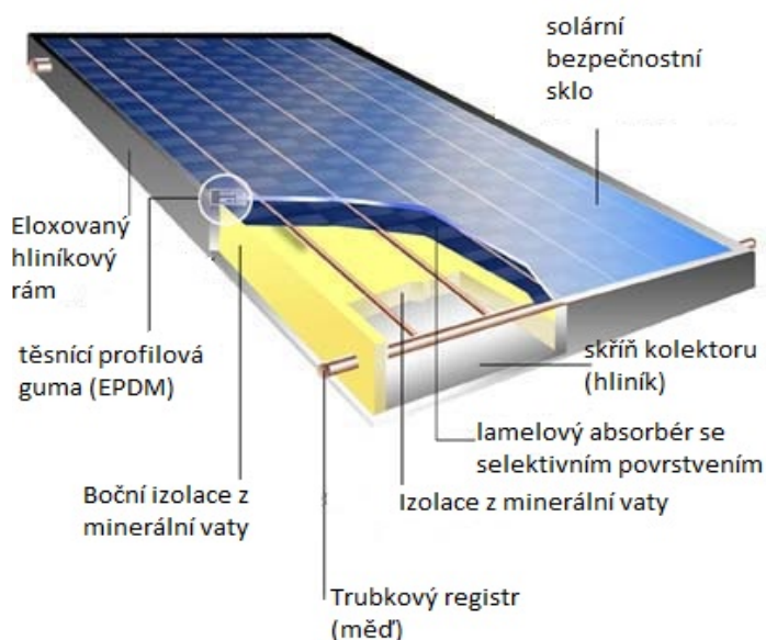
Obr. 6.1. Řez fototermickým kolektorem [05]
