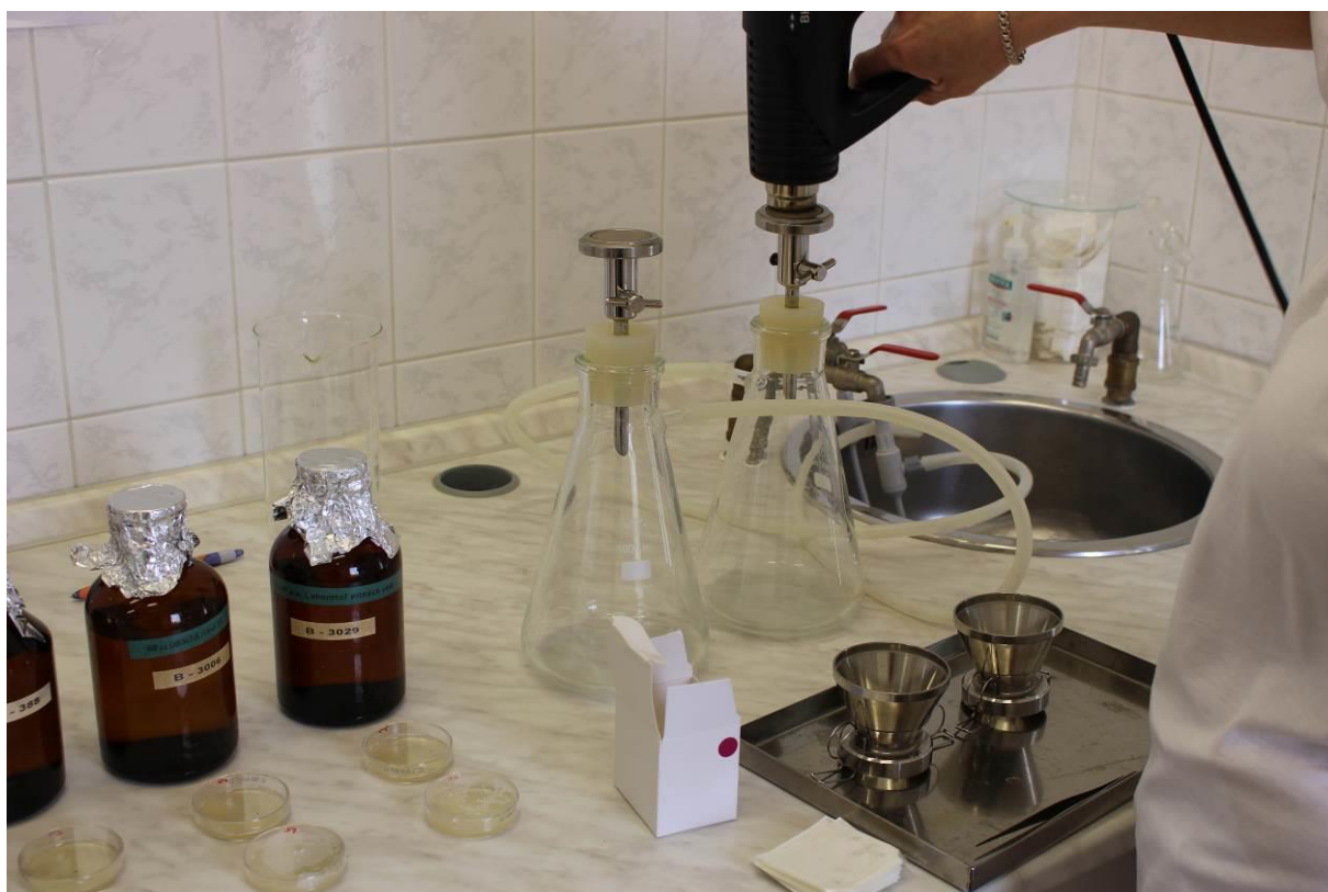
Obrázek 8: Sterilizace porézního disku spodní části filtračního aparátu pomocí horkovzdušné pistole.
