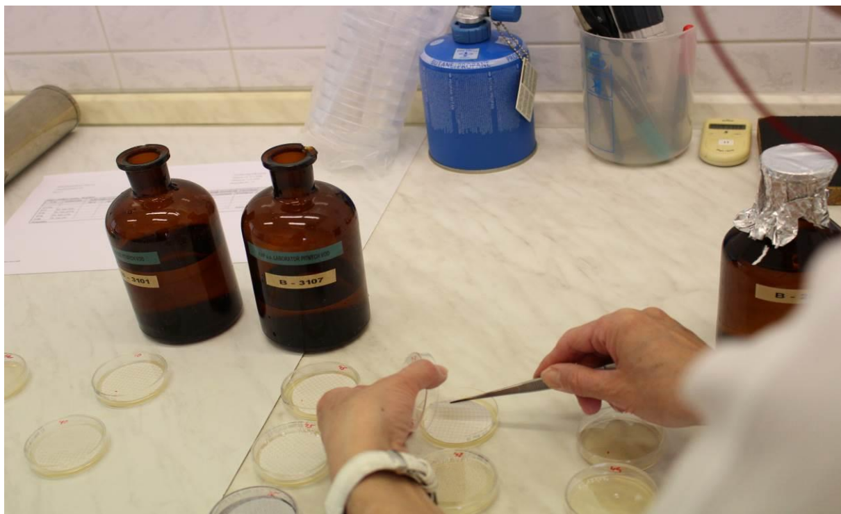
Obrázek 15: Pomocí pinzety se filtr přenese na povrch kultivačního média tak, aby mezi filtrem a médiem nevznikly vzduchové bubliny.
