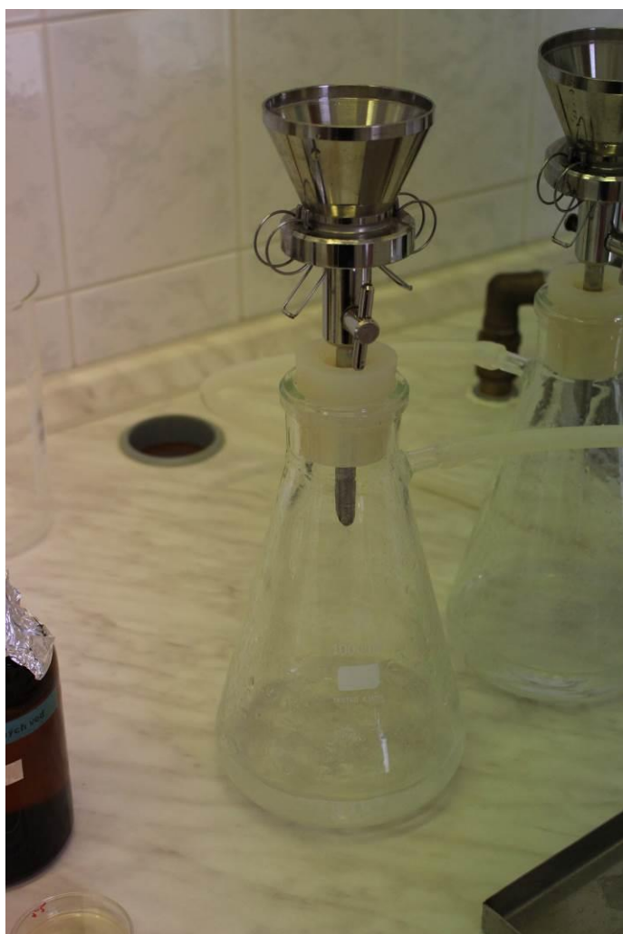
Obrázek 14: Kohoutek u nálevky se otevře a vzorek se nechá pomalu protéct a přefiltrovat přes membránový filtr. Poté se kohoutek ihned uzavře.
