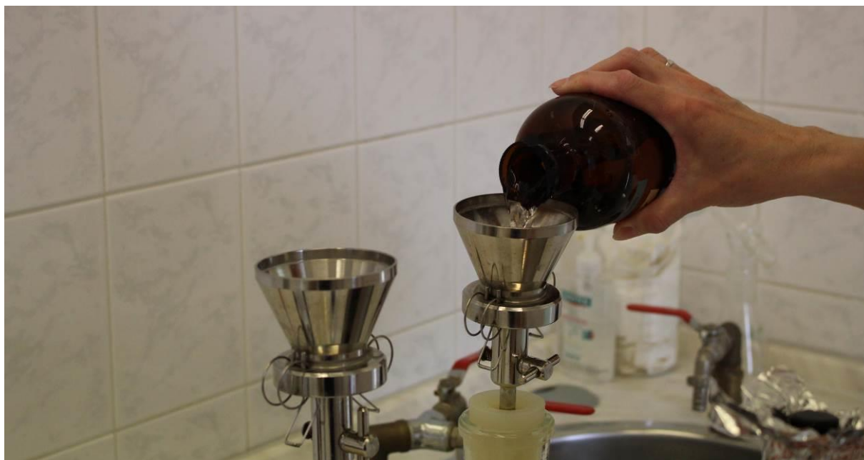
Obrázek 13: Do nálevky se nalije vzorek o objemu 100 ml (po rysku nálevky).
