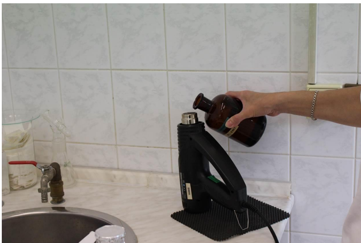
Obrázek 12: Okraj hrdla vzorkovnice se ožehne nad horkovzdušnou pistolí. (Vzorkovnice musí být předem vytemperovaná a protřepaná.)
