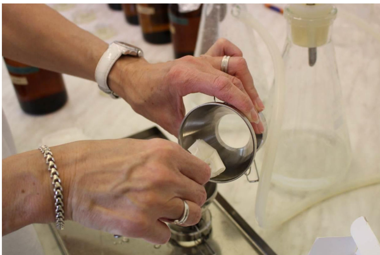
Obrázek 10: Dezinfekce části filtračního aparátu vatou namočenou do lihu a poté pomocí horkovzdušné pistole.
