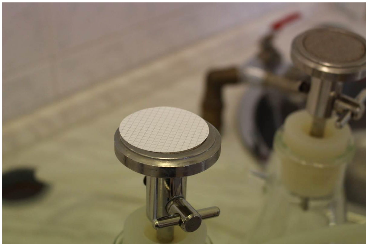
Obrázek 9: Sterilní membránový filtr se za okraj přenesse ožehnutou pinzetou na porézni disk mřížkovanou stranou vzhůru.
