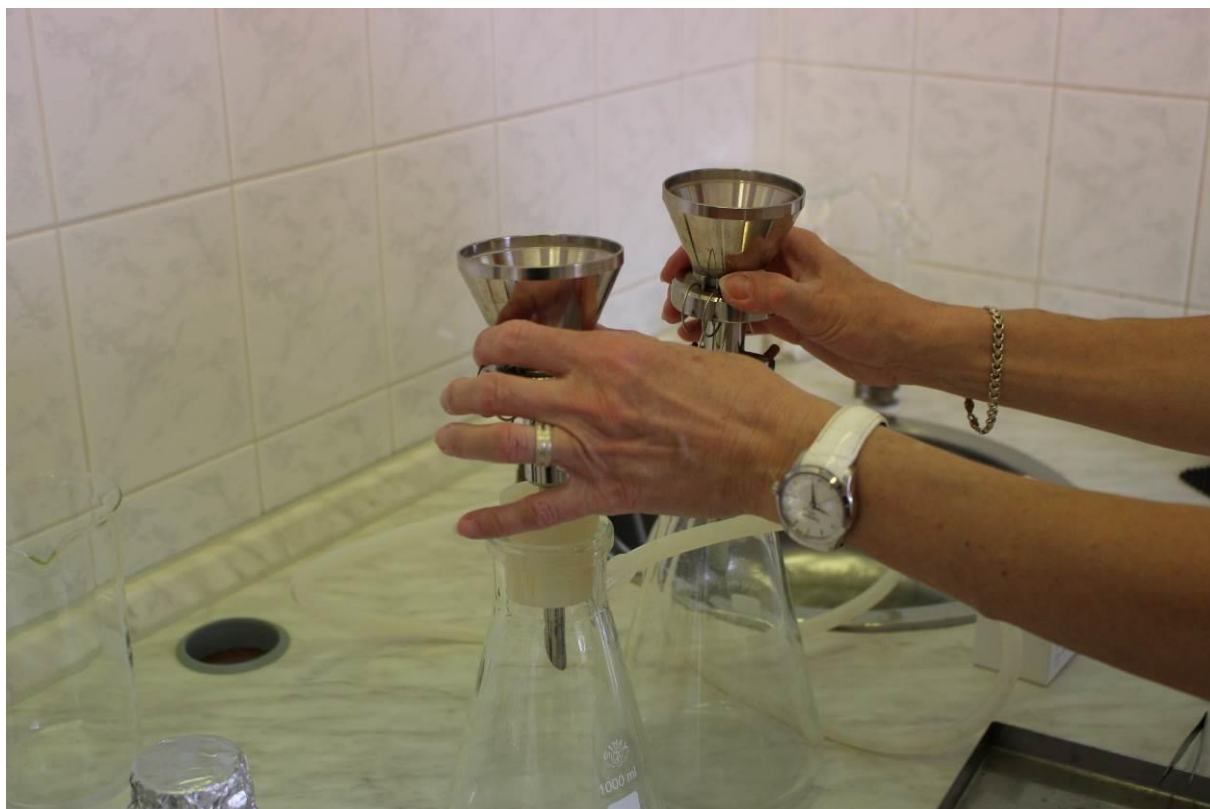
Obrázek 11: Na spodní část aparátu se připraví sterilní nálevka a zavře se kohoutek na aparátu.
