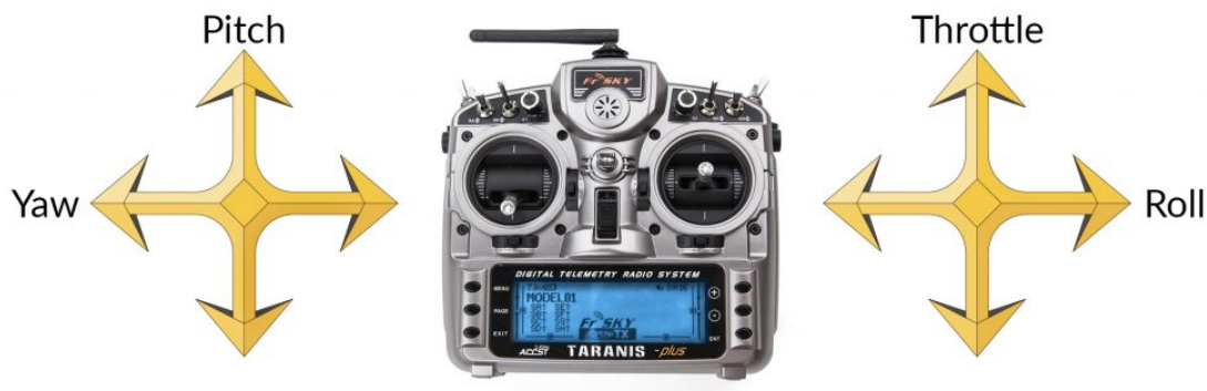
Obrázek 2.2: Mode 1 má plyn umístěný na pravém joysticku společně s kloněním (roll).
