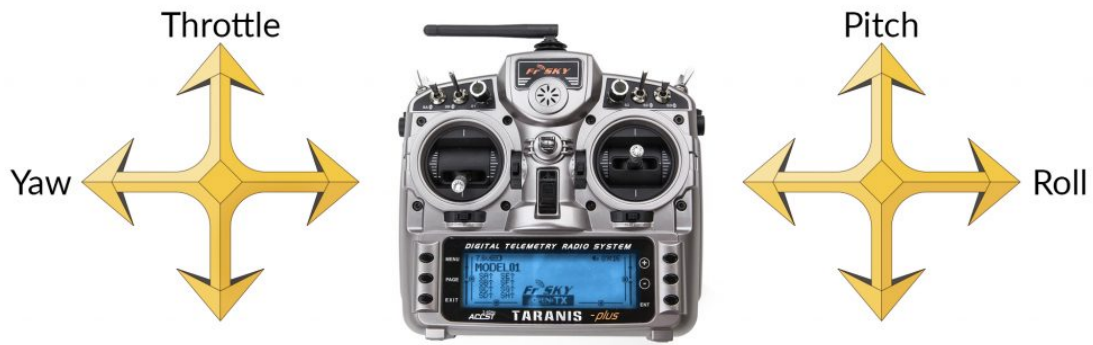
Obrázek 2.3: Mode 2 má plyn umístěný na levém joysticku společně se zatáčením (yaw). 4
