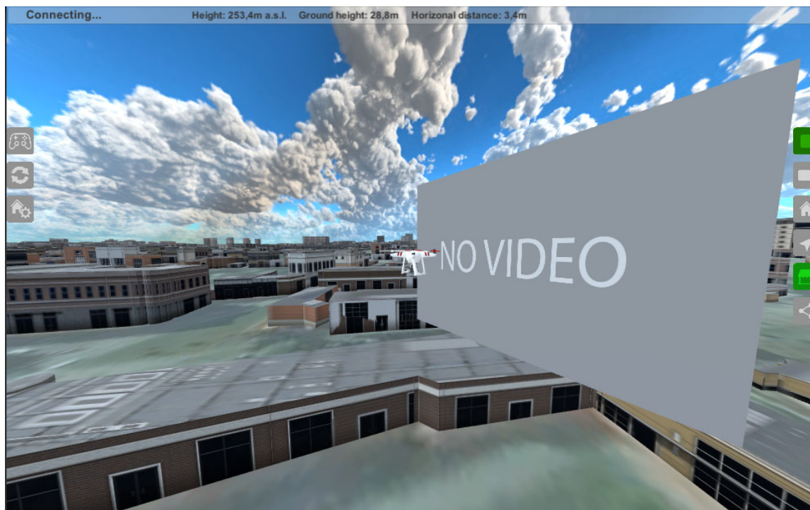
Obrázek 4.6: Virtuální obrazovka pro zobrazení videa se pohybuje v určité (uživatelé nastavené) vzdálenosti před dronem a otáčí se společně s fyzickou kamerou na gimbalu. Na obrázku je vidět netypický pohled z boku.
