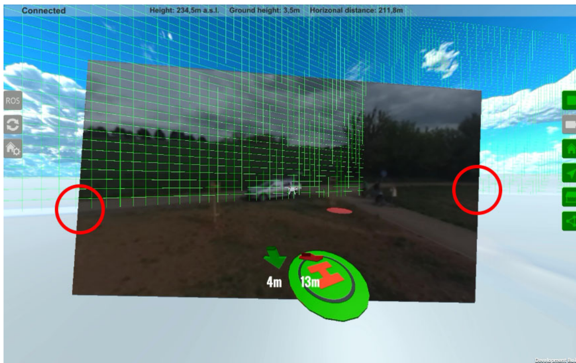
Obrázek 5.3: Virtuální zdi se osvědčily při létání uvnitř oblasti, pohyb po jejich okraji byl ale značně náročný, protože se špatně odhadovala jejich vzdálenost. Nepříjemné bylo také prolínání virtuální zdi s virtuální obrazovkou, které působilo poněkud rušivě. Na obrázku je také vidět, že mapový podklad na obraz z videa poměrně dobře navazuje (zakroužkováno).
