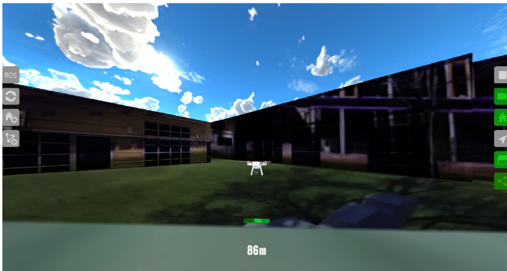
Obrázek 5.5: Přesnost senzorů naprosto nedostačovala při zobrazení videa pomocí projektoru na budovy, jejichž modely jsou navíc samy značně nepřesné. Potíže může způsobovat také samotný video projektor v Unity, ten je totiž pravděpodobně určený pro výrazně jednodušší projekce. Projekci na terén, která by pravděpodobně fungovala mnohem lépe však nebylo možné vyzkoušet, protože kameru na dronu nelze sklopit směrem dolů.
