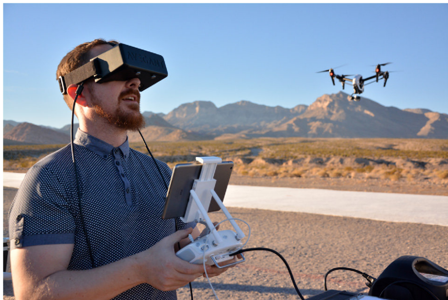
Obrázek 2.4: Někteří piloti pro řízení dronu přes video využívají brýle, do kterých je přenášén obraz z kamery na dronu. 6
