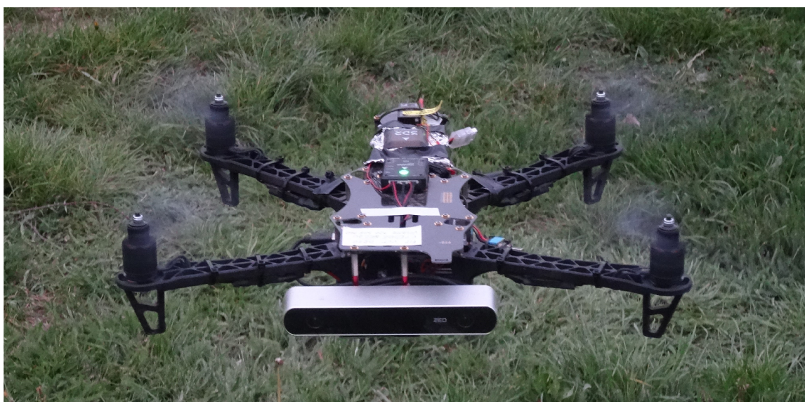
Obrázek 5.1: Testovací dron s řídicí jednotkou Pixhawk, stereoskopickou kamerou ZED a superpočítačem Nvidia Jetson vyfocený za letu těsně nad zemí.
