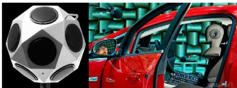
Obrázek 17: Všesměrový zdroj hluku a figurína s mikrofóny [26]
