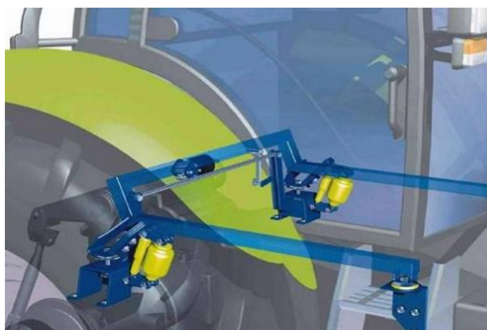
Obrázek 73: Návrh pneumatického odpružení kabiny traktoru [41]
