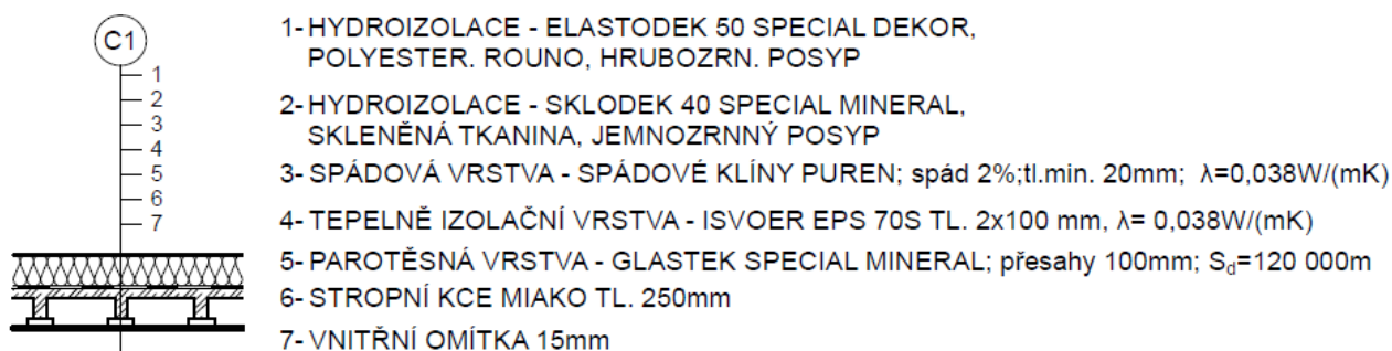
Obr. 22 Skladba střechy bez vegetační vrstvy.
