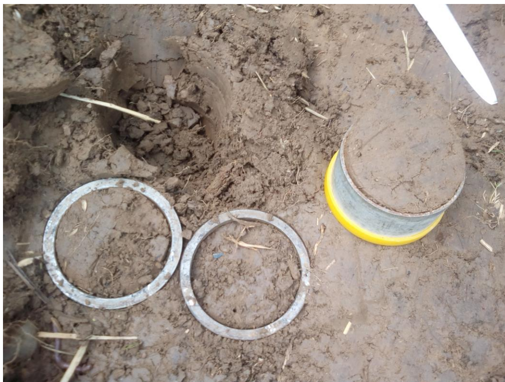
Obrázek č. 4 - Vyjmutý a seříznutý Kopeckého váleček
