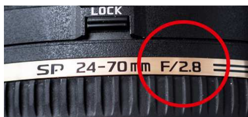
Obr. 64 Informace o cloně na objektivu
