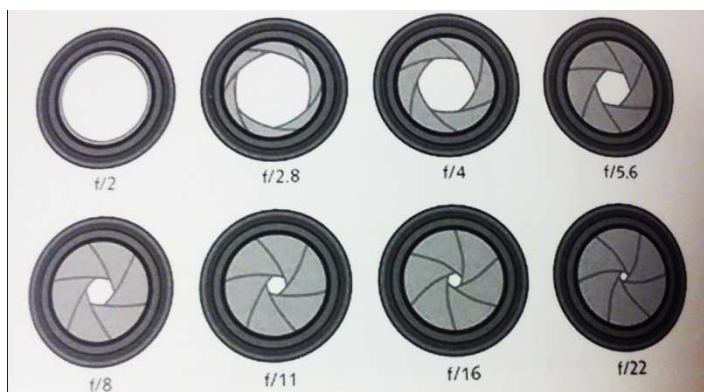
Obr. 65 Regulace prostupu světla objektivem pomocí clonových lamel [13]
