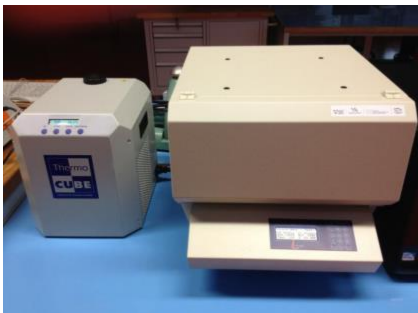
Obr. č. 5 Přístroj na měření tepelné vodivosti FOX 314 [49]
