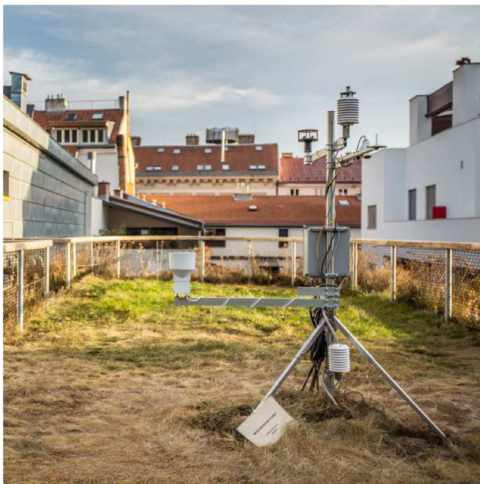
Obrázek 4, Meteostanice na střeše objektu C. [3]
