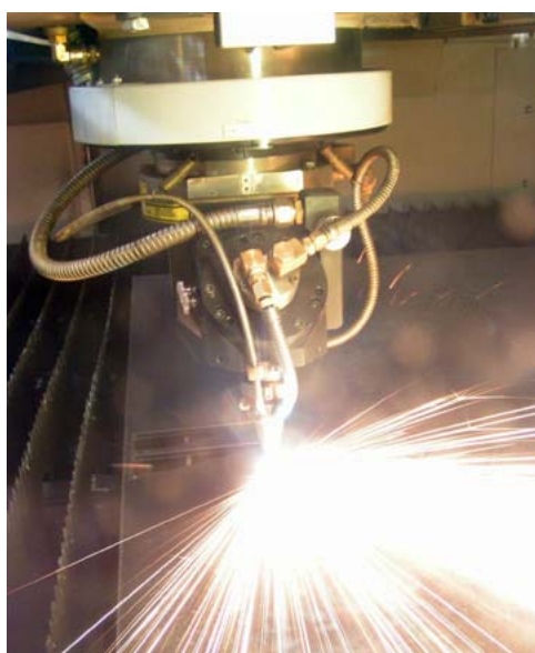
Obr. 4.7 Rotační pálicí hlava stroje MAZAK Space Gear 510
