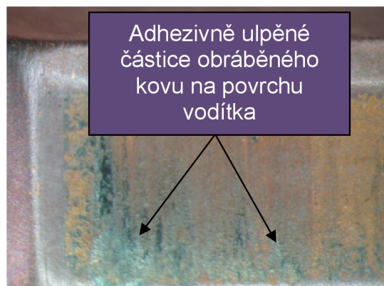
Obr. 4.13 Geometrie vodítka opotřebované vystružovací hlavice MT3
