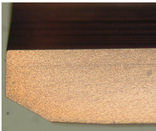
Obr. 4.10 Geometrie břitu nové vystružovací hlavice MT3
