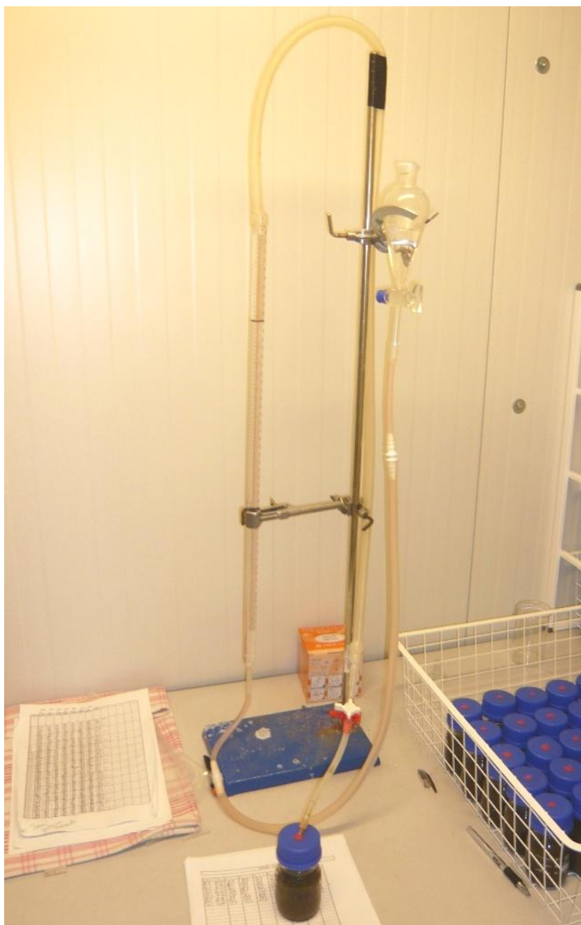
Obr. č. 7 – Plynoměrná byreta s testovanými lahvičkami
