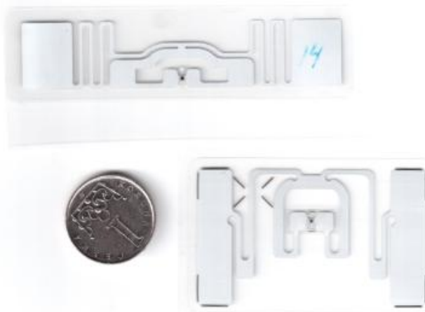
Obrázek 1.1 Pasivní UHF tagy, ukázka rozměrů
