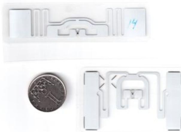
Obrázek 1.1 Pasivní UHF tagy, ukázka rozměrů
