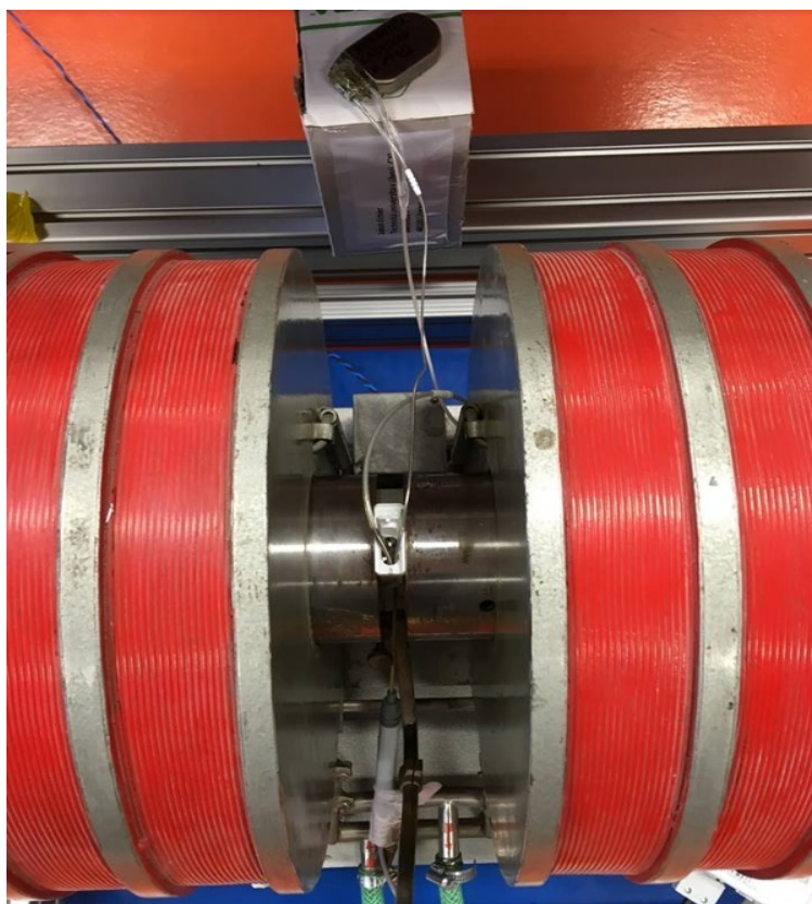
Obrázek 66: Rozložení fantomu CRT-D a říditelných cívek během měření. Distální část komorové elektrody ve fyziologickém roztoku byla umístěna do minimální vzdálenosti od zdroje EMP. Stimulátor je stranou pro umožnění telemetrie. Zdroj autor.
