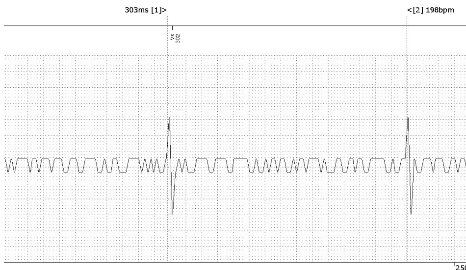
Obrázek 62: Intermitentní detekce EMI jako vlastní akce (Vs). Sekvence několika krátkých impulzů v burstu je zpracováním CIED vykreslena jako jeden signál. Na obrázku bursty po 300 ms. Rychlost posunu 250 mm/s. Bipolární vektor. Zdroj autor.
