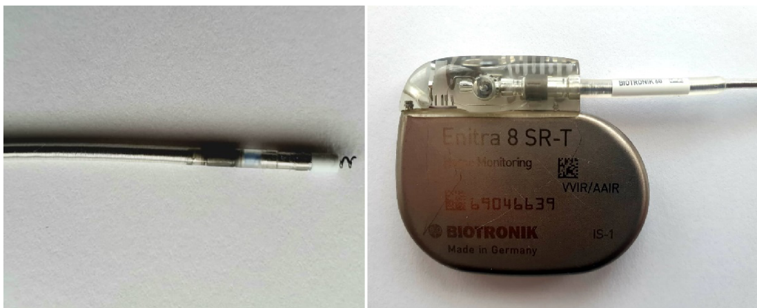
Obrázek 24: Distální a proximální část aktivní bipolární elektrody. Zdroj autor.
