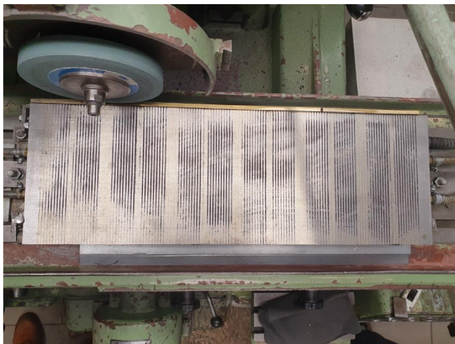
Obrázek 49: Orientace siločar elektromagnetu znázorněná využitím kovového prachu. Zdroj autor.
