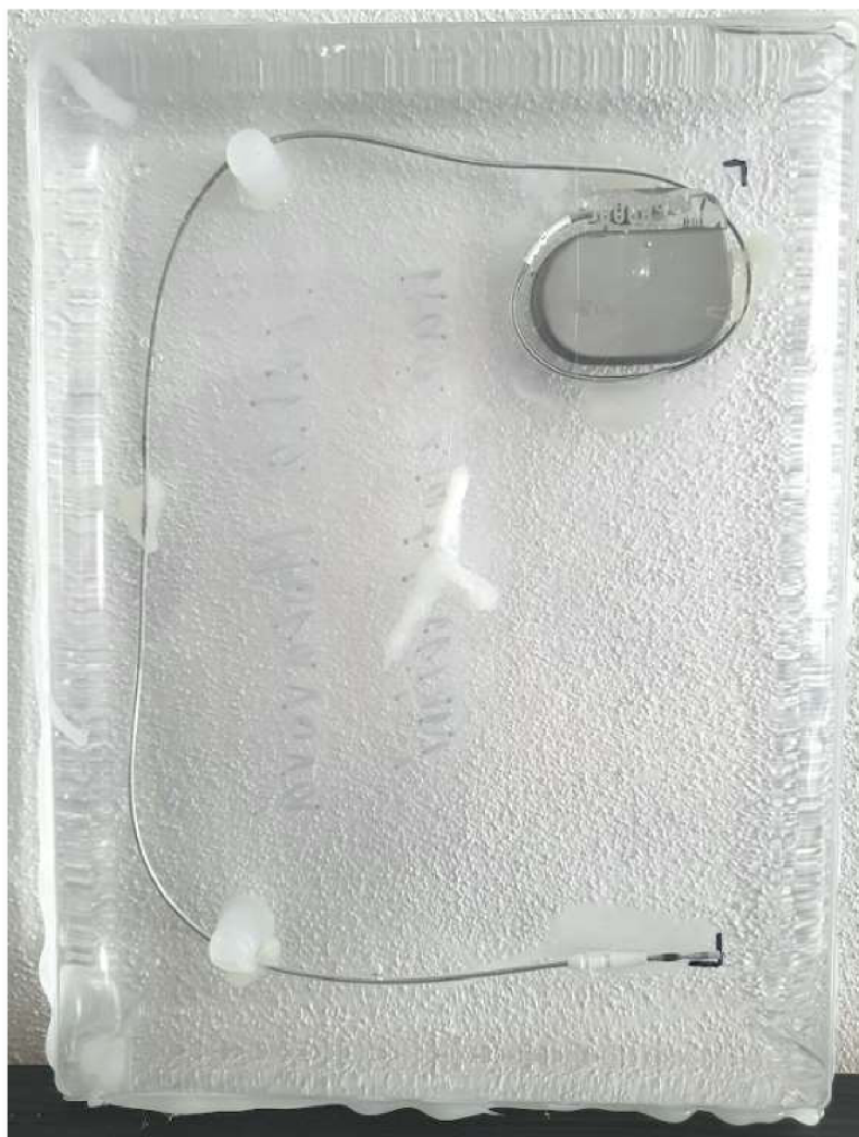
Obrázek 47: Fantom vybraného implantovaného 1D PCM pro účely studie. Zdroj autor.
