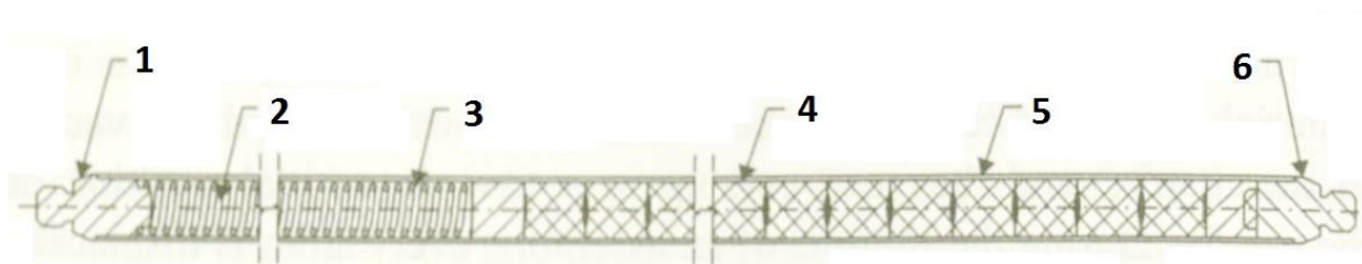
Obr. 4.6: Palivová tyč (proutek): 1 - horní koncovka; 2 – pružina; 3 – místo pro hromadění plynných štěpných produktů; 4 – palivová peleta; 5 – povlaková trubka; 6 – spodní koncovka [1]
