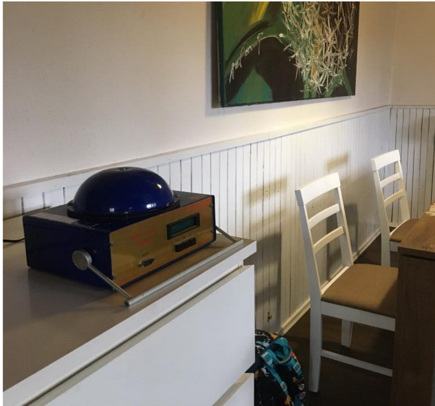
Obr. 27: Osazení monitorovacího zařízení Radim 3AT ve vnitřním prostředí (indoor)
