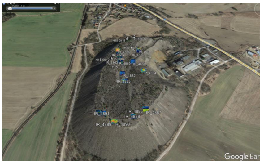
Obr. 31: Zaměření hot spot bodů termokamerou v 3D prostředí Google Earth
