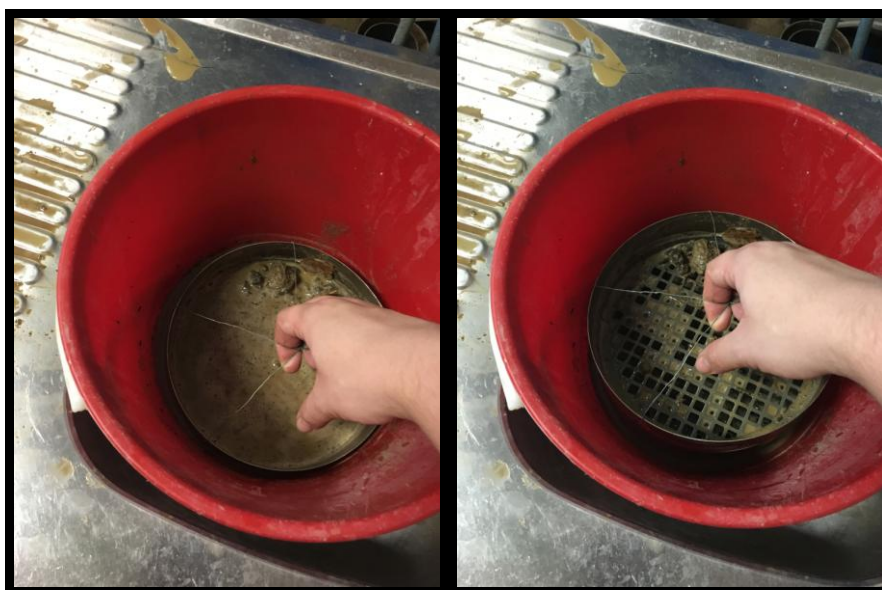
Obr. 15 Propírání vzorků ve kbelíku. Vlevo ponoření vzorku a vpravo vytažení vzorku z vody (Macháček, 2017).
