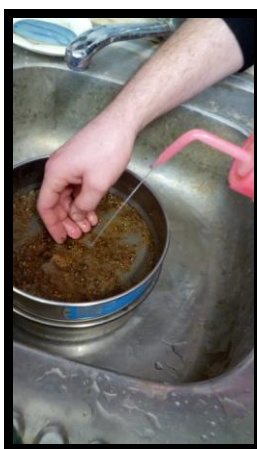
Obr. 20 Promílání vzorku destilovanou vodou (Macháček, 2017)
