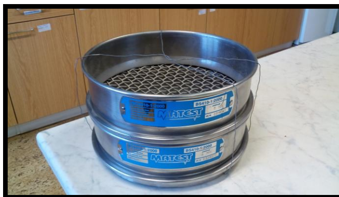
Obr. 14 Soustava sít připravená k prosívání (Macháček, 2017).
