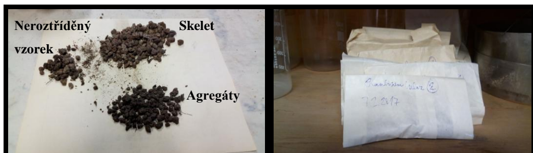
Obr. 17 Třídění vzorků. Vlevo třídění půdních agregátů ze vzorku. Vpravo uložení vytříděných vzorků. (Macháček, 2017).
