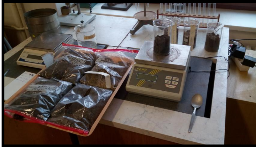
Obr. 12 Navážení vzorku v laboratoři mechaniky zemin (Macháček, 2017).
