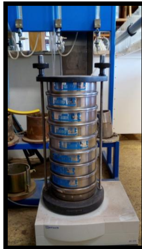
Obr. 19 Připravená sada sít na třesačce (Macháček, 2017).
