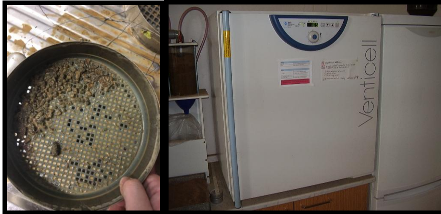
Obr. 16 Propírání vzorků. Vlevo obsah vodostabilních agregátů na síti. Vpravo zařízení pro vysoušení půdních vzorků (Macháček, 2017).
