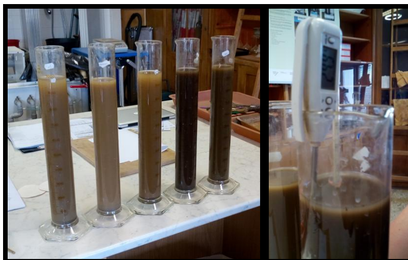
Obr. 21 Připravené roztoky. Vlevo rozmíchané roztoky jednotlivých půdních typů. Vpravo měření teploty a hustoty roztoku (Macháček, 2017).
