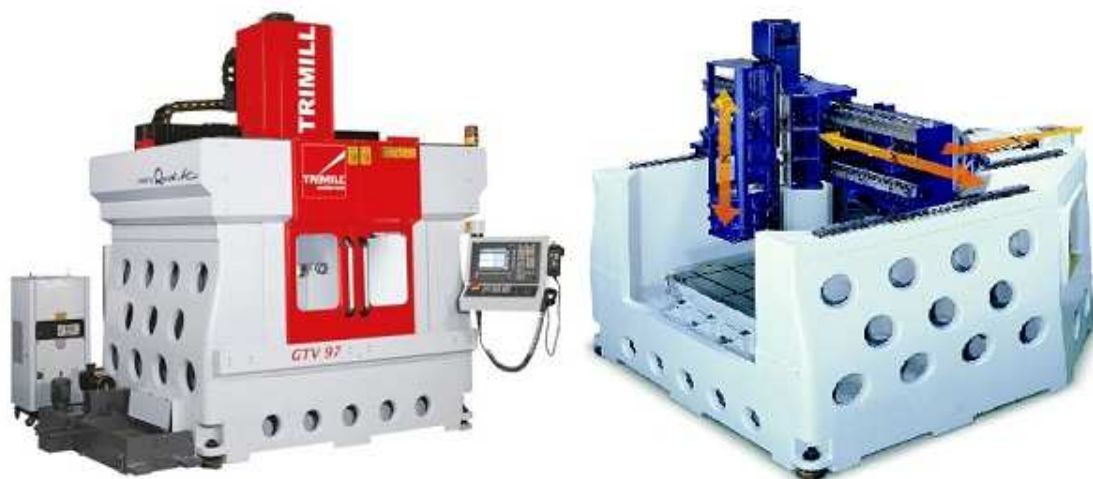
Obr. 21: Litinové lože tohoto stroje je součástí pohledových částí GTV 97 (TRIMILL) [25]
