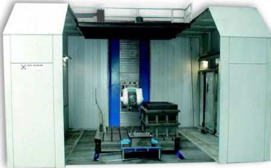
Obr. 9: Horizontální obráběcí centrum FO (TOS Kuřim) [15]
