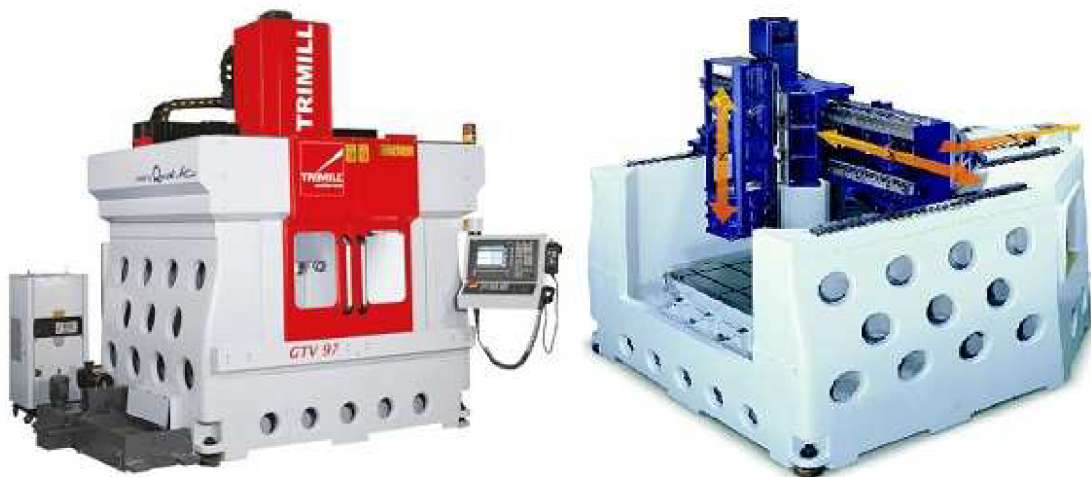
Obr. 21: Litinové lože tohoto stroje je součástí pohledových částí GTV 97 (TRIMILL) [25]
