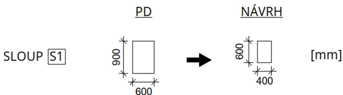
Obr. 2.4 – Sloup S1 – úprava rozměrů průřezu
