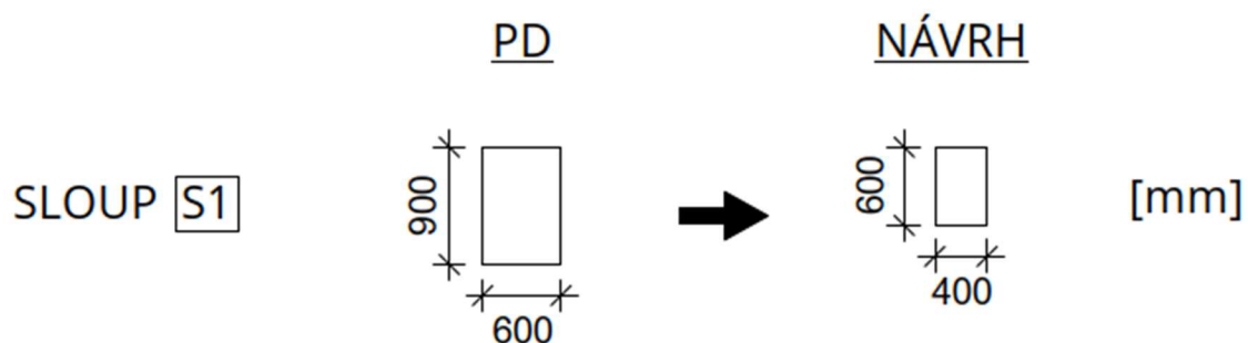
Obr. 2.4 – Sloup S1 – úprava rozměrů průřezu
