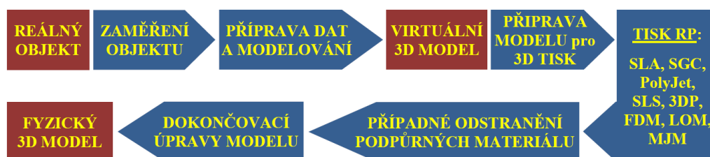
Obr. 11: Proces vzniku fyzického 3D modelu reálného objektu
