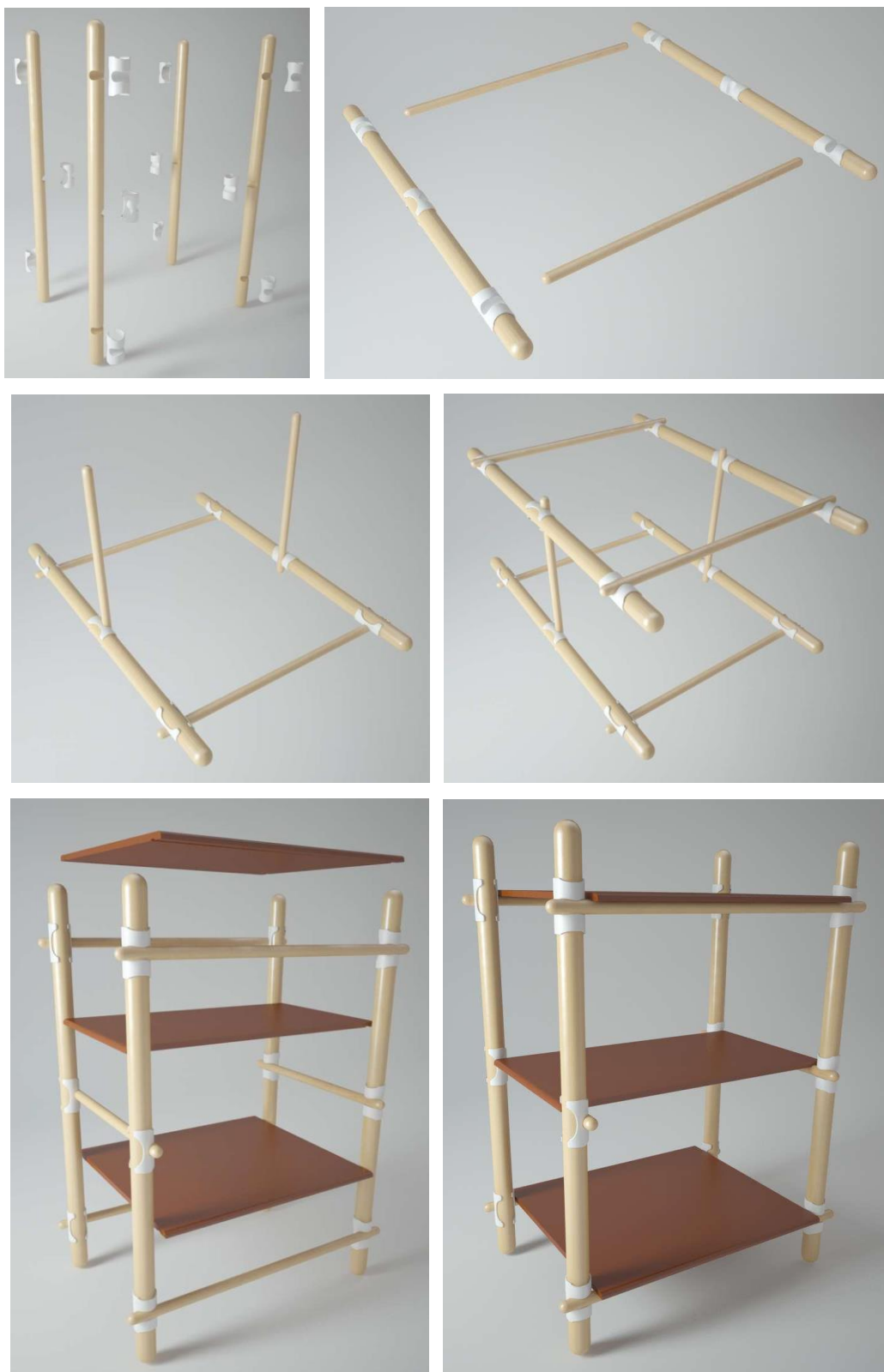
Obr. 82: Znáznornění montáže vybrané varianty
