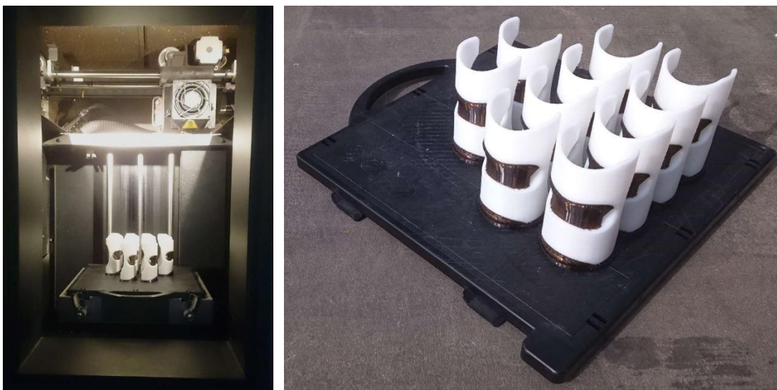
Obr. 76: Fotografie z tisku konstrukčního spoje
