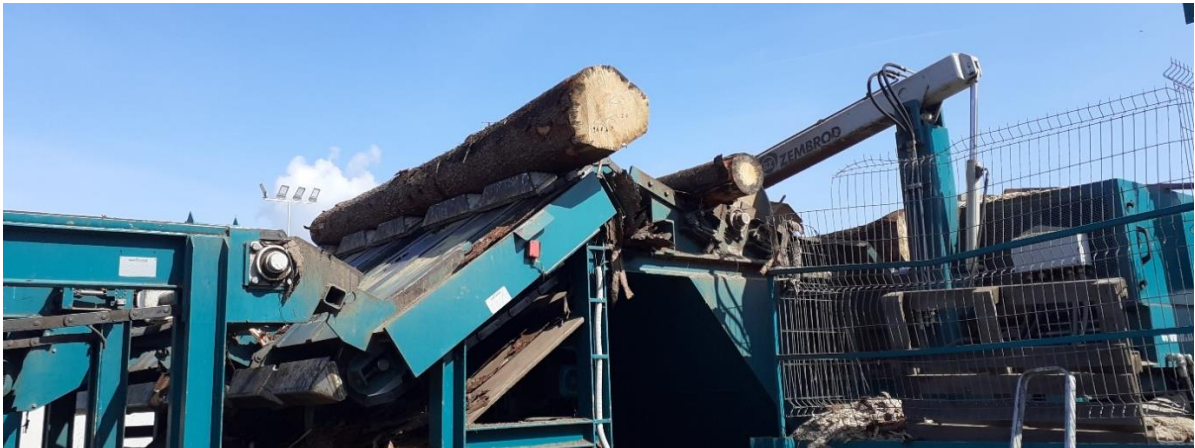
Obrázek 5: Elevátor (rozebírač kmenů)
