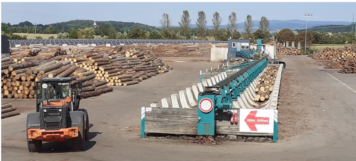
Obrázek 11: Podélný třídící dopravník
