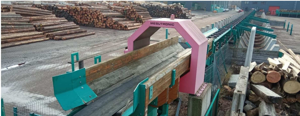
Obrázek 10: Detektor kovu METRON® 05 CO s podávacím pásem
