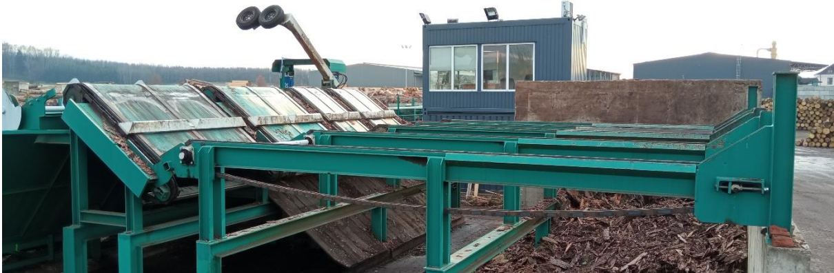
Obrázek 4: Příčný řetězový dopravník zásobní
