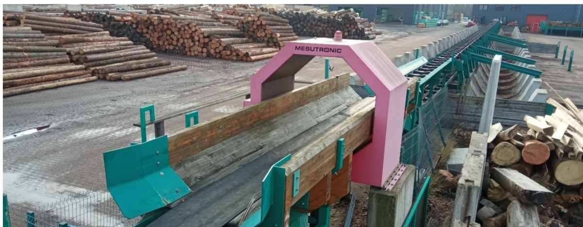
Obrázek 10: Detektor kovu METRON® 05 CO s podávacím pásem
