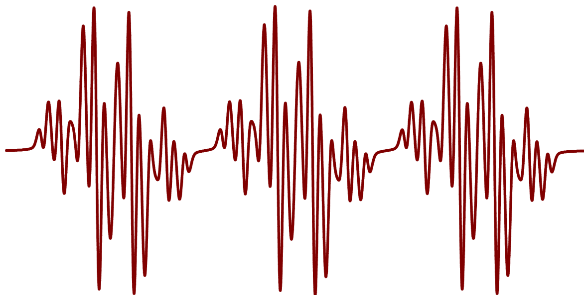
Obr. 30 Experimentální EPR spektrum pozorované v systému Luperox 101 (39) + NB +PbO 2 a jeho spektrální simulace.
