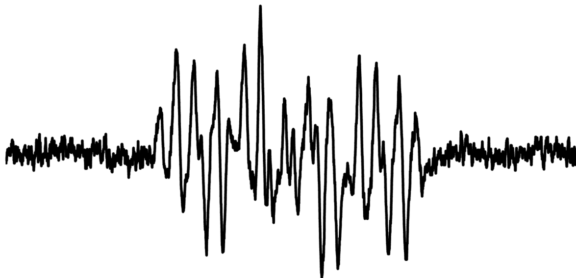
Obr. 8 Experimentální EPR spektrum primárního volného fenoxylvého radikálů pozorované v systému 14b + Co(acac)+TBHP.
