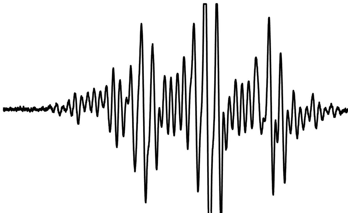
Obr. 6 Experimentální EPR spektrum radikálové směsi obsahující signál primárního fenoxylu společně se signálem radikálového aduktu 13 na nitrosobenzenu pozorované v systému 12b + NB + PbO 2 .
