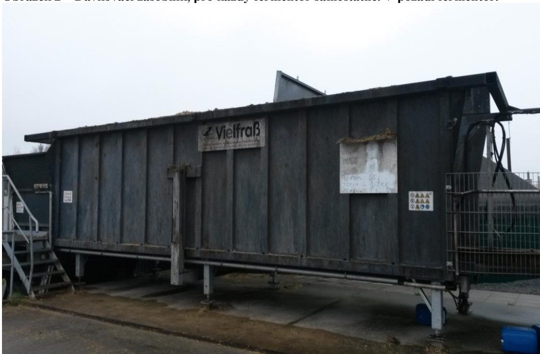
Obrázek 2 – Dávkovací zásobník, pro každý fermentor samostatně. V pozadí fermentor.
