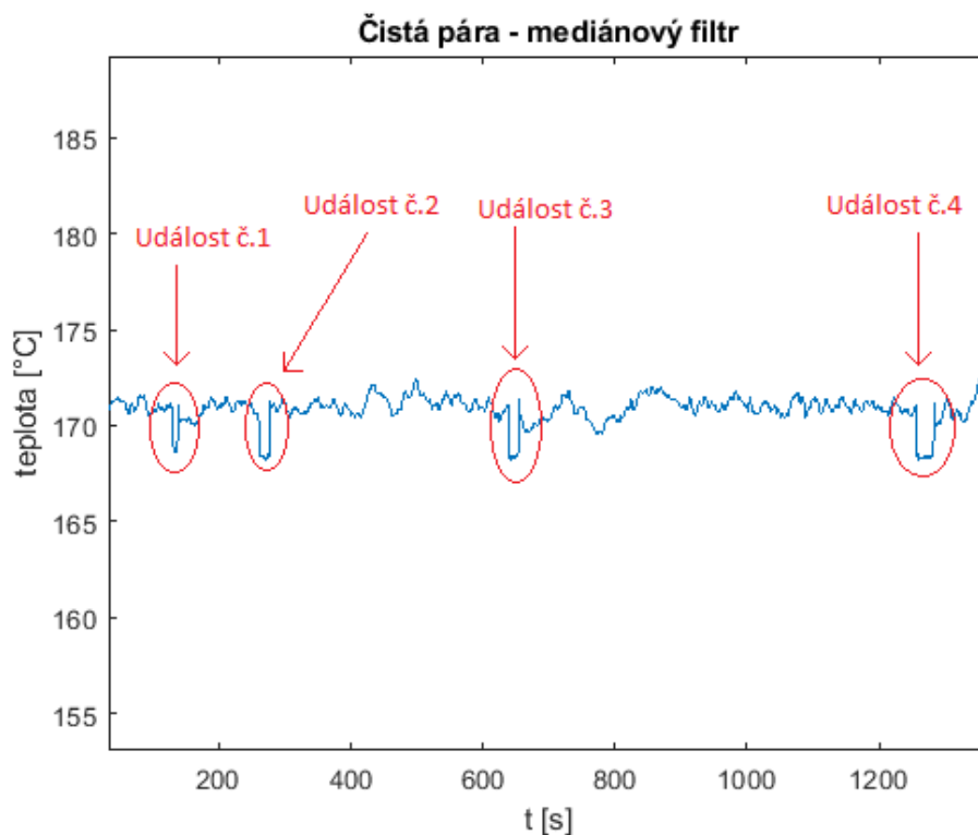
Obr. 25: Signál teploty po filtraci mediánovým filtrem (10 průměrovaných hodnot)
