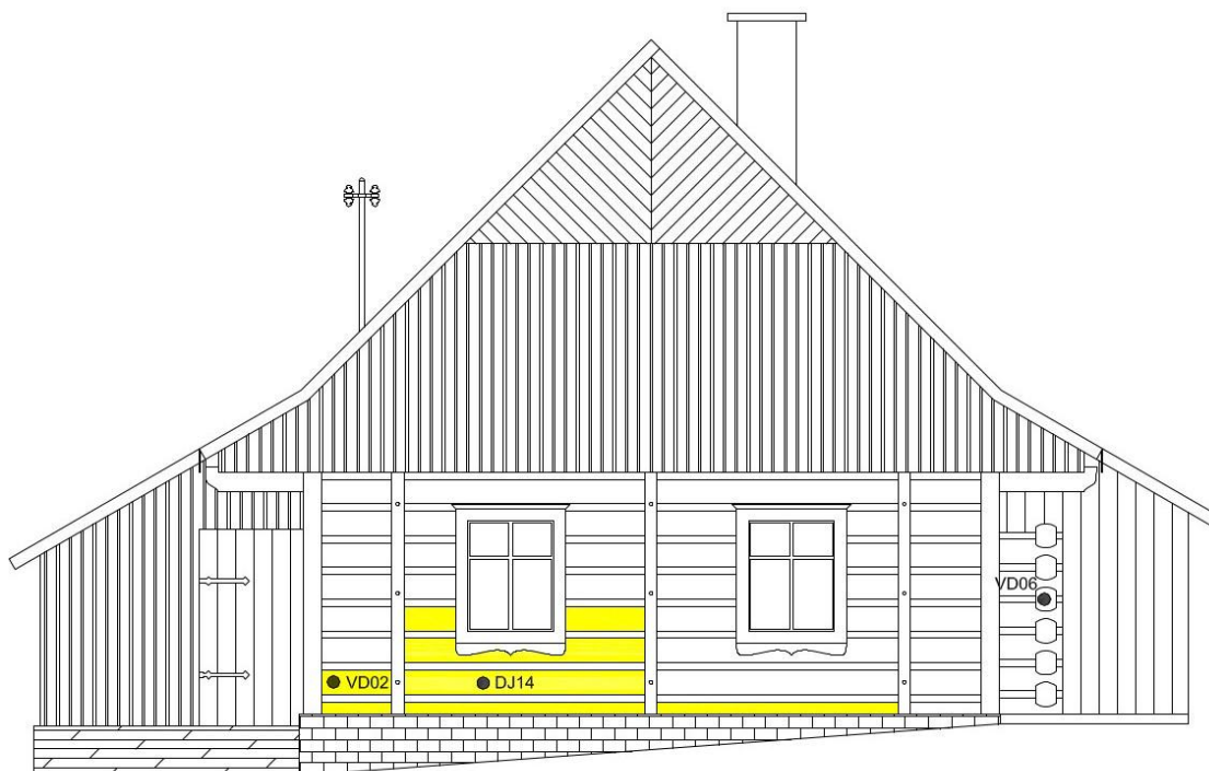
Obr. 21: Západní štítová strana objektu (zdroj: vlastní tvorba) – pozn.: žluté plochy představují poškozenou oblast, body místa měření a odebrání vzorků
