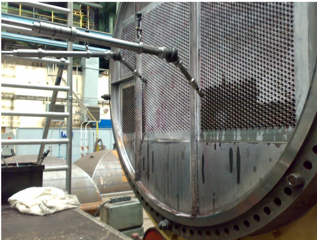
Obr. 4.9 – Detail trubkovnice pro přehřívák-odlučovák páry na ETE [34]
