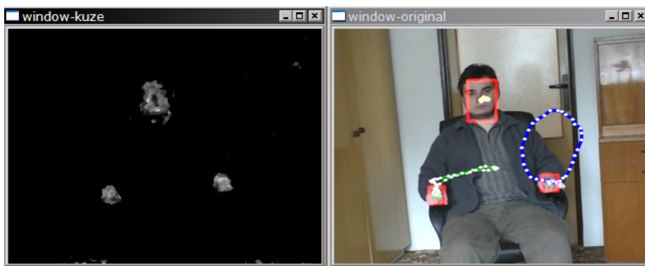
obrázek 2: Ukázka aplikace. Vlevo výstup detekce pokožky, vpravo video s vyznačenými oblastmi a trajektoriemi
