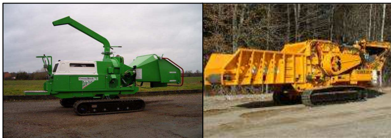
Obrázek 16 - Štěpkovač na pásovém podvozku STC 220MT55 SAFE-Track (zdroj: firma GreenMech), štěpkovač na pásovém podvozku CBI 6400T (zdroj: firma Vermeer)
