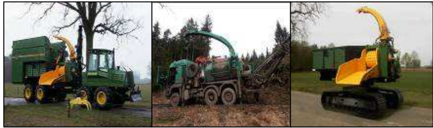
Obrázek 12 - Štěpkovač nesený na forwardéru (zdroj: firma Dutch Dragon), na nákladním automobilu (zdroj: autor), na pásovém podvozku (zdroj: firma Dutch Dragon)
