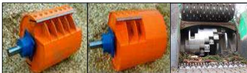
Obrázek 20 - Buben s dvěma noži po celé délce, buben s děleným nožem posunutým o 180° (zdroj: firma Bruks), buben s děleným nožem na více segmentů (zdroj: autor)
