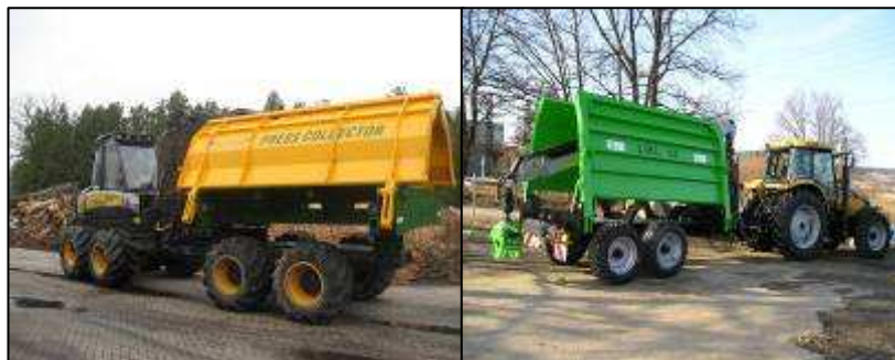
Obrázek 6 - Kompresní sběrač na forwardéru (zdroj: firma Dutch Dragon), kompresní sběrač na vyvážecím vleku (zdroj: firma STS Prachatice)
