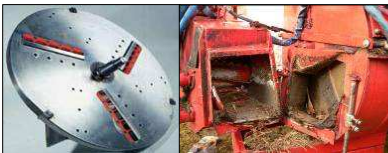
Obrázek 18 - Disk štěpkovače se třemi noži (zdroj: firma Linddana), pohled na otevřený vstupní otvor diskového štěpkovače (zdroj: autor)
