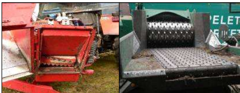
Obrázek 25 - Podávací zařízení diskového štěpkovače s otevřeným vstupním trychtýřem, podávací zařízení bubnového štěpkovače (zdroj: autor)
