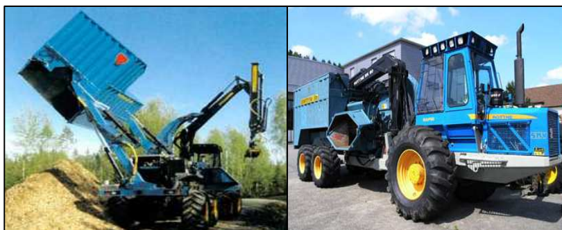
Obrázek 15 - Terénní štěpkovač BRUKS 805 CT vysypání neseného kontejneru, pohled na stroj v přepravní poloze (zdroj: firma Bruks)
