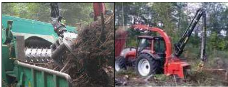
Obrázek 24 - Bubnový štěpkovač s mechanickým dávkováním (zdroj: autor), diskový štěpkovač s mechanickým dávkováním (zdroj: firma Linddana)
