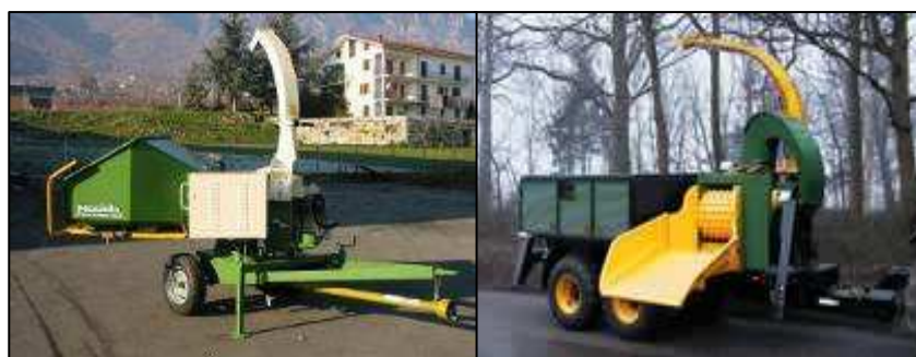
Obrázek 11 - Tažený štěpkovač na jednonápravovém (zdroj: firma Pezzolato), dvounápravovém vleku (zdroj: firma Dutch Dragon)
