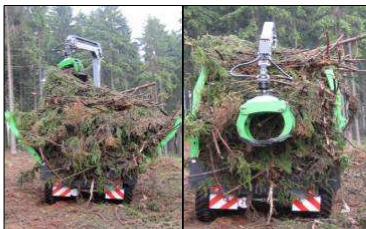
Obrázek 5 - Kompresní sběrač LIKL 14, zadní pohled v průběhu nakládání, zadní pohled po kompresi (zdroj: firma STS Prachatice)
