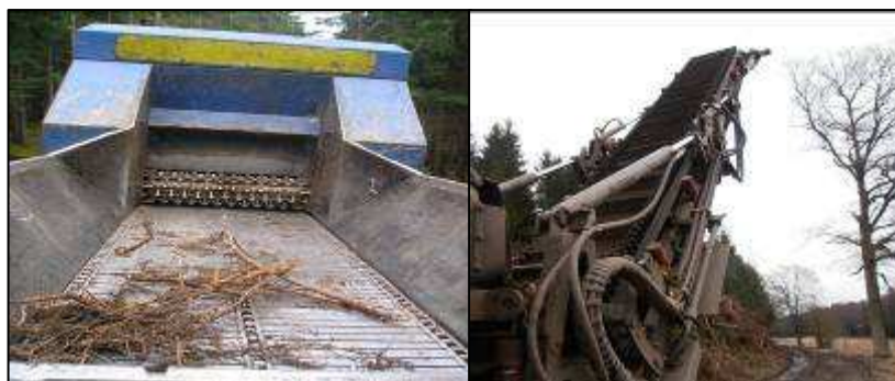
Obrázek 30 - Podávací pás drtiče pro vložený materiál, pásový dopravník pro odvod drtě (zdroj: autor)
