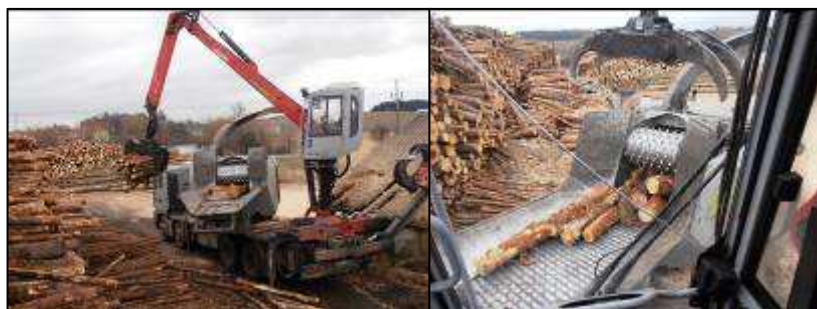
Obrázek 14 - Samostatná kabina štěpkovače, pohled z kabiny na podávací zařízení (zdroj: autor)
