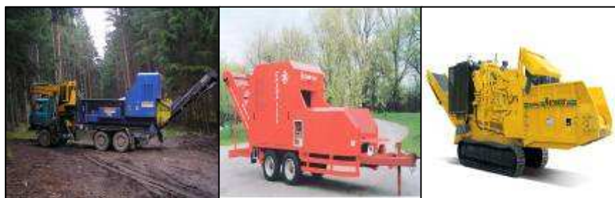
Obrázek 29 - Drtič na podvozku nákladního automobilu (zdroj: autor), dvouosém vleku (zdroj: firma Davos), pásovém podvozku (zdroj: firma Vermeer)
