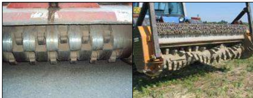
Obrázek 8 - Rotor půdní frézy s volně uloženými pracovními nástroji (zdroj: autor), pevně uložené pracovní nástroje (zdroj: firma Berti)
