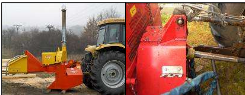
Obrázek 10 - Štěpkovač nesený na tříbodovém závěsu (zdroj: firma Rabaud), vývodový hřídel od traktoru určený k pohonu štěpkovače (zdroj: autor)
