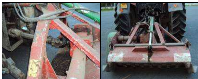
Obrázek 9 - Hnací hřídel a úhlová převodovka půdní frézy boční pohled, zadní pohled (zdroj: autor)
