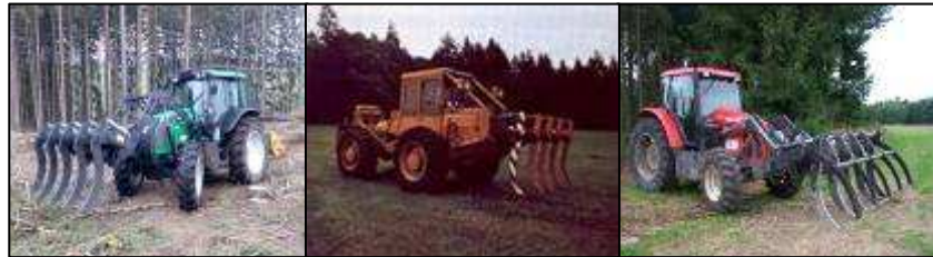
Obrázek 1 - Čelní shrnovačem klestu na UKT (zdroj: firma Forest Meri), čelní shrnovač klestu na SLKT (zdroj: firma Vlk project), aktivní shrnovač klestu (zdroj: firma Forest Meri)
