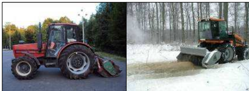
Obrázek 7 - Půdní fréza nesená vzadu (zdroj: autor), půdní fréza nesená vpředu (zdroj: firma Some)
