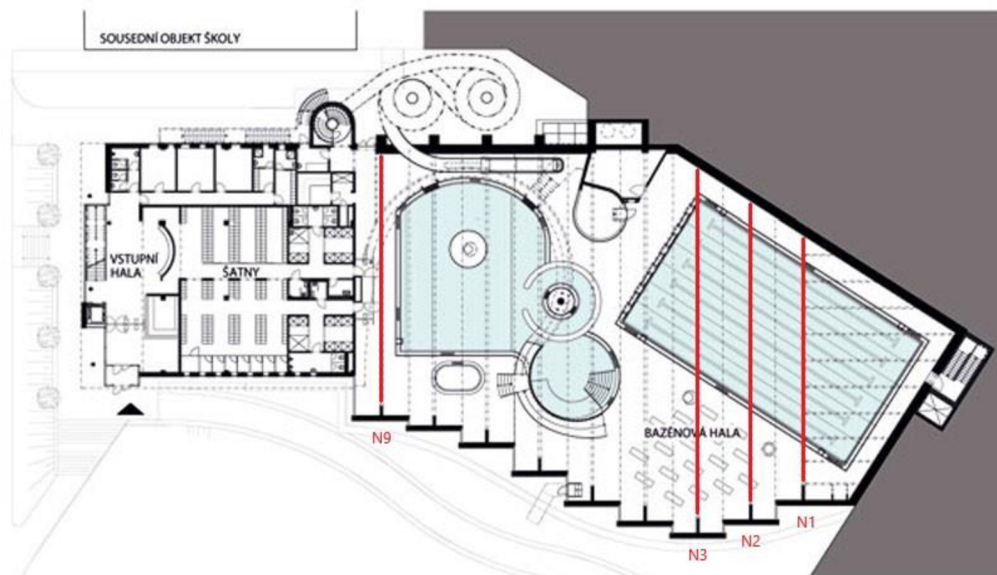
Obrázek 15 – Rozmístění sledovaných střešních nosníků [12, úprava-autor]
