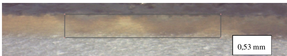
Obr. 53 Makrostruktura vzorku číslo 4, výkon 5 kW, rychlost 1,6 \text{ m} \cdot \text{min}^{-1}
