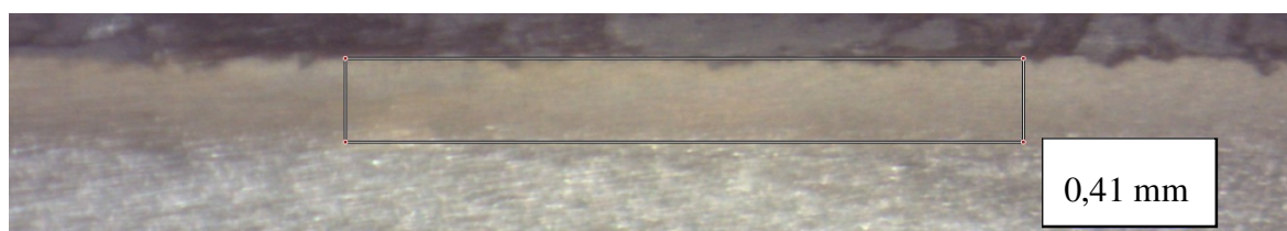
Obr. 55 Makrostruktura vzorku číslo 6, výkon 5 kW, rychlost 2,0 \text{ m}\cdot\text{min}^{-1}
