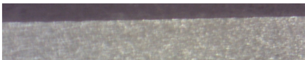
Obr. 62 Makrostruktura vzorku číslo 14, teplota 1200°C, rychlost 2,0 m·min -1
