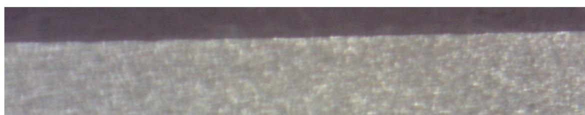
Obr. 62 Makrostruktura vzorku číslo 14, teplota 1200°C, rychlost 2,0 m·min -1
