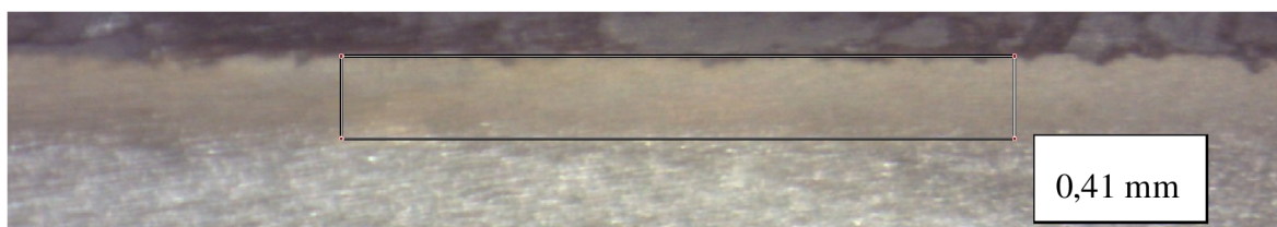
Obr. 55 Makrostruktura vzorku číslo 6, výkon 5 kW, rychlost 2,0 \text{ m} \cdot \text{min}^{-1}
