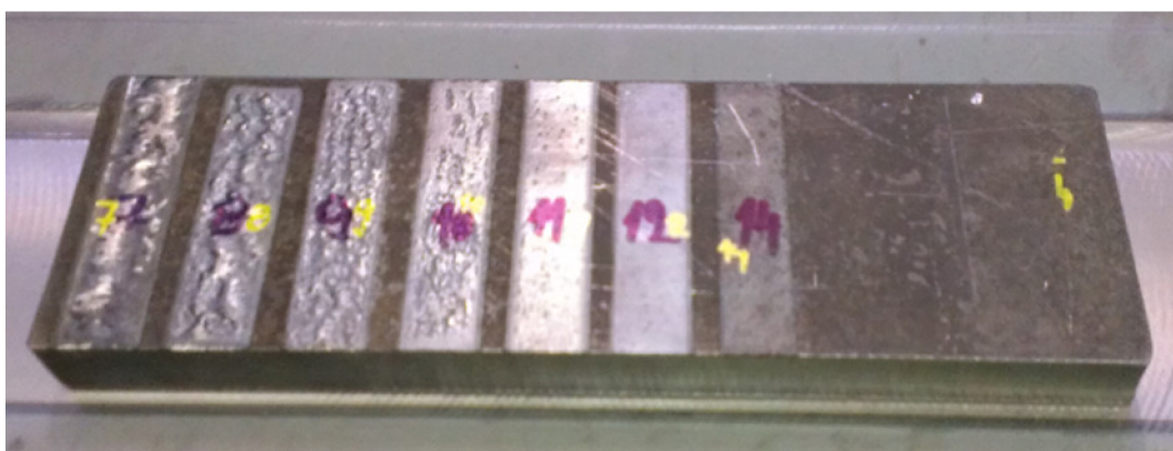
Obr. 47 Vzorky 7 až 14 po povrchovém kalení
