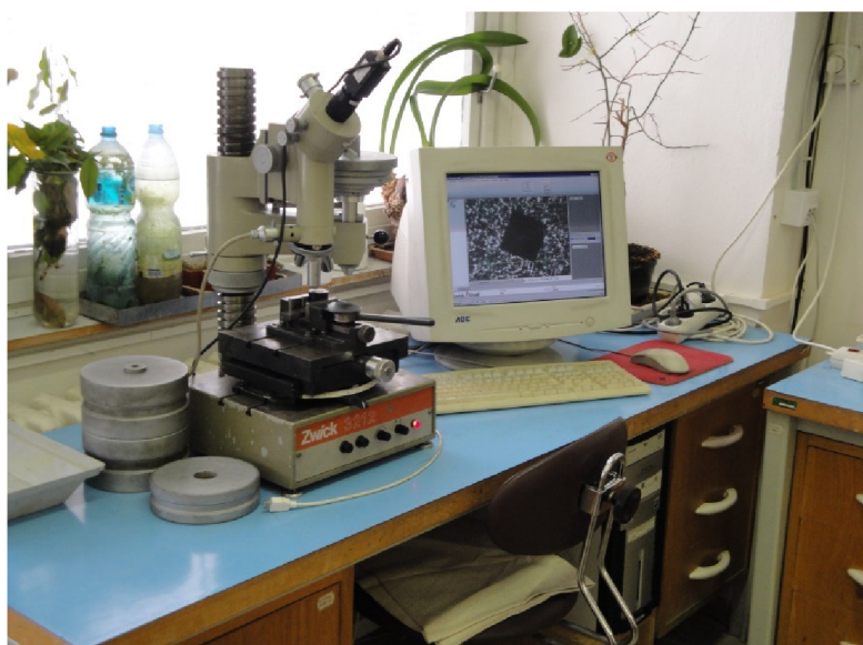
Obr. 43 Tvrdoměr Zwick na Ústavu strojírenské technologie FSI VUT v Brně
