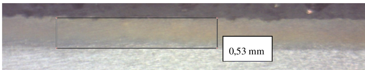
Obr. 54 Makrostruktura vzorku číslo 5, výkon 5 kW, rychlost 1,8 \text{ m} \cdot \text{min}^{-1}
