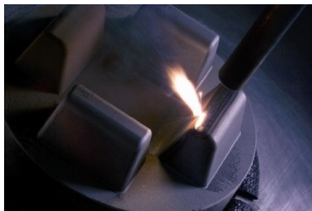
Obr. 31 Úprava povrchu vysoce namáhaných tvářecích nástrojů [29]
